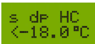
Рисунок 12. Состояние индикатора, когда dpW выше dpHC .
